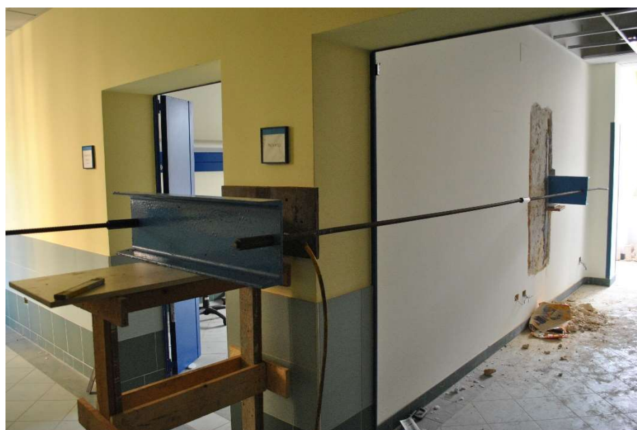
Fig.9. Profilo UPN e martinetto, posti nel corridoio.
