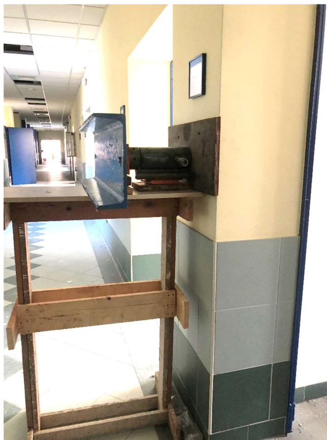
Fig.9. Profilo UPN e martinetto, posti nel corridoio.
